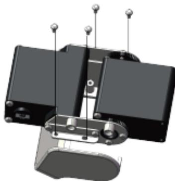
06 装上与舵机连接的金属手掌, 拧紧螺丝;
